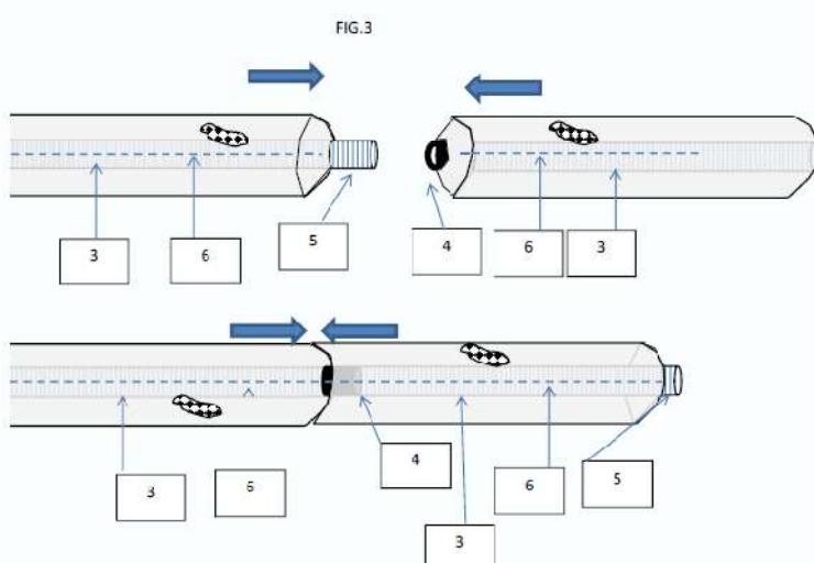
Die Verbindung wird hergestellt, indem das Rohr an der Unterseite der Entwässerungsplatte verlängert wird, um ein Außengewinde zu bilden. Dieses wird in ein Innengewinde mit Kunststoffhülse auf der gegenüberliegenden Seite der Platte eingeführt, um eine perfekte hydraulische Abdichtung zu gewährleisten. Material: Polypropylen. Außendurchmesser: 160 mm.
